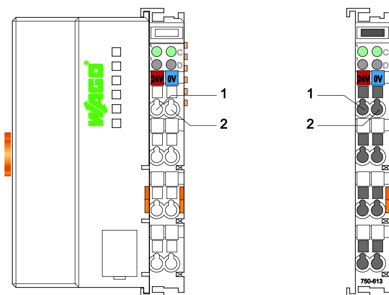
Abbildung 5: Systemversorgung über Feldbuskoppler/-controller (li.) und über Potentialeinspeiseklemme (re.)
