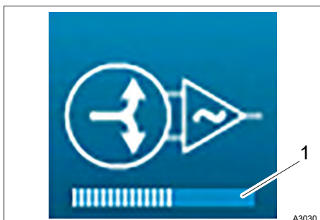
Abb. 36: 4 ... 20mA-Ausgang im Übertragungsmodus
