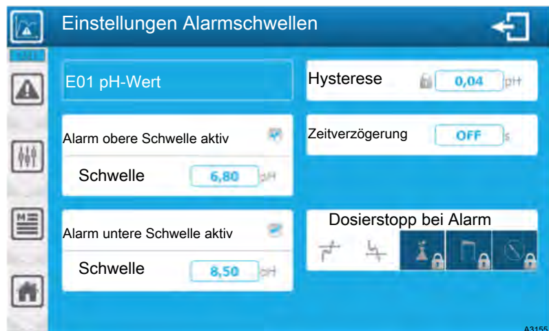
Abb. 104: Einzelne Parameter (hier E01) einstellen
