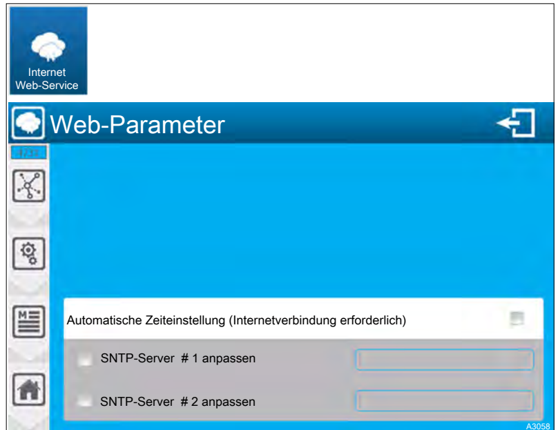
Abb. 62: Internet- und Webserver-Konfiguration [4731]
