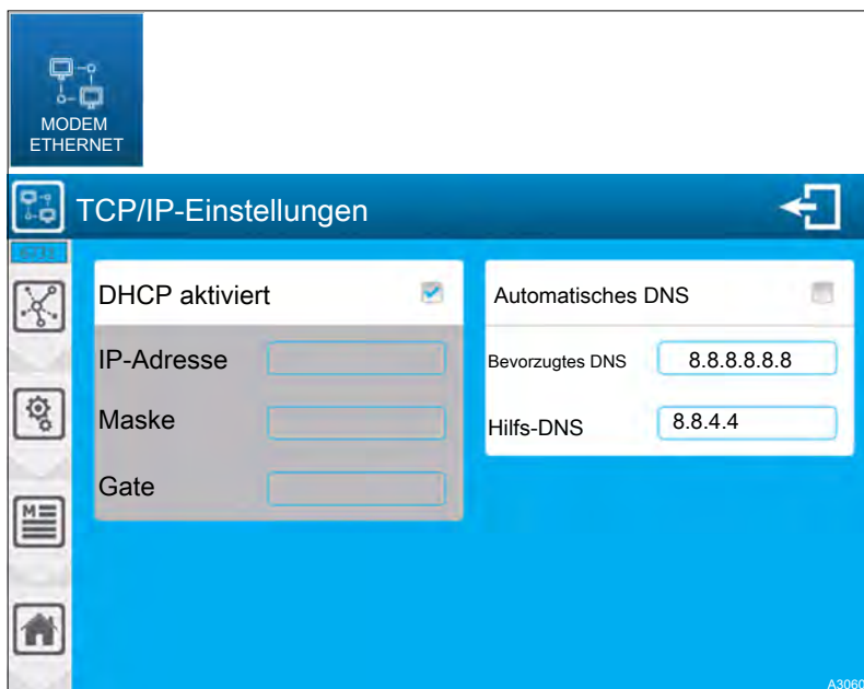
Abb. 64: Konfiguration des Ethernet-Modems [6731]
