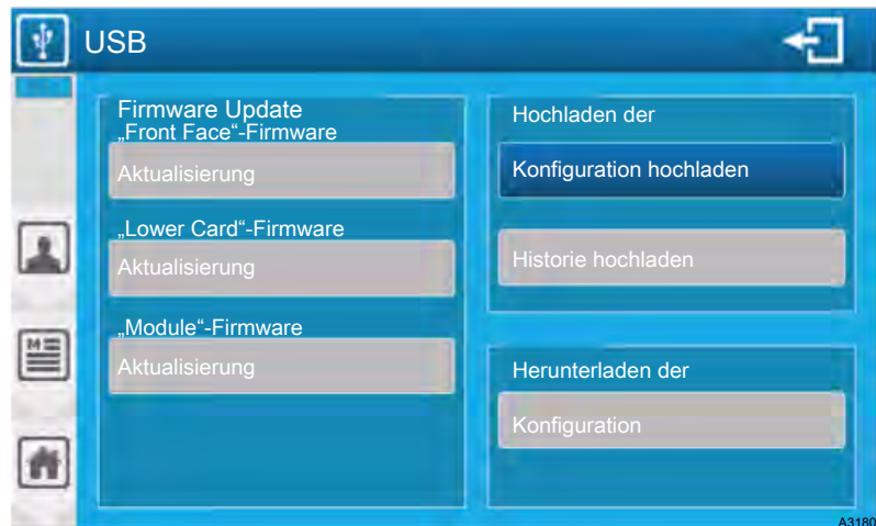
Abb. 121: Um auf dieses Menü (Programmierbildschirm) zuzugreifen, müssen Sie einen USB-Stick einstecken.
