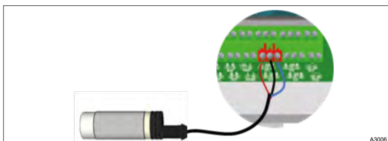
Abb. 15: Anschluss eines Strömungsschaltersensors am DI2
